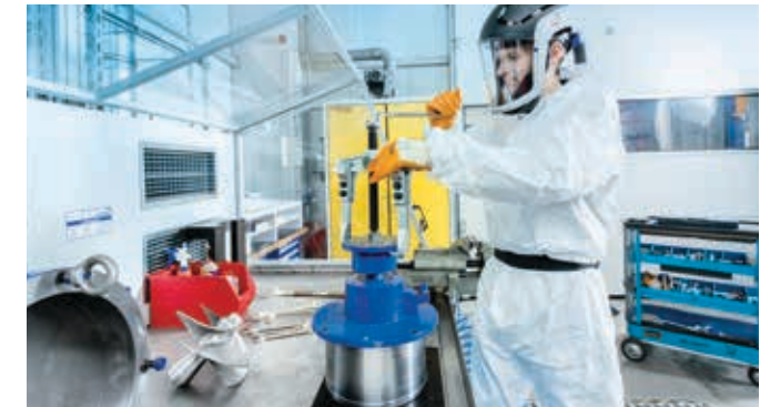
Der KSB-Chemiearbeitsplatz: Mit funkenfreien Werkzeugen werden die Pumpen und Armaturen sowie artverwandte Komponenten demontiert.
