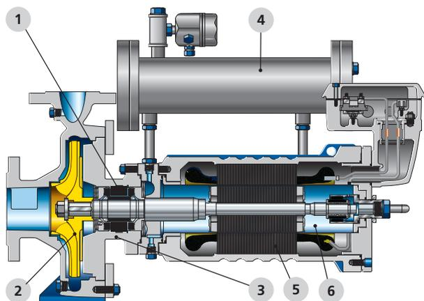
Кроме того, перегородка, новая разработка KSB, обеспечивает отделение проточной части от двигателя: при этом тепло не передается в роторное пространство, и твердые частицы перекачиваемой среды не попадают в привод.
