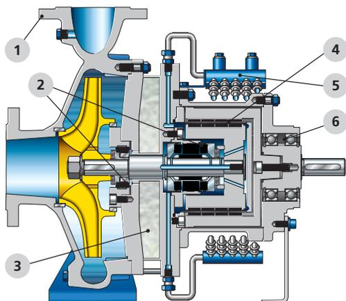
смазывающей среды. Таким образом, отсекаются ферро-магнитные твердые частицы в перекачиваемой среде, которые могли бы повредить магнитный стакан и вызвать износ подшипников скольжения.
