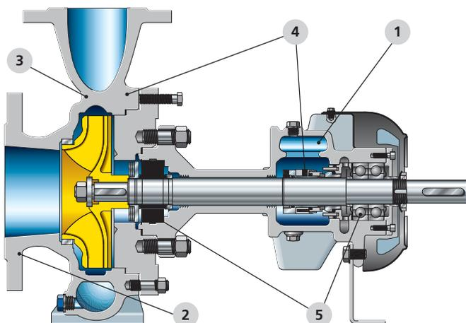
Подпор азотом, паром или вазелиновым маслом предотвращает образование продуктов крекинга на уплотнительных поверхностях. Кроме того, благодаря модульной конструкции обеспечивается быстрая и простая замена торцевого уплотнения.
