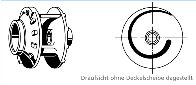
Abb. 57: Geschlossenes Einschaufelrad für Abwasser mit festen oder langfaserigen Beimengungen
