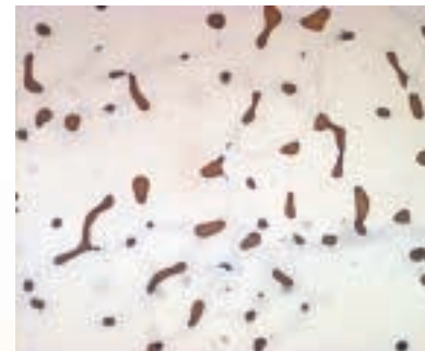
Gefüge: Austenitisch mit ca. 10–15% Delta-Ferrit
