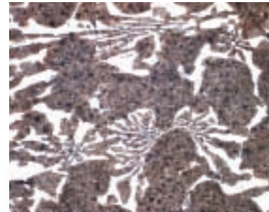
Gefüge: Martensitische Matrix mit Primär- und Sekundärkarbiden
