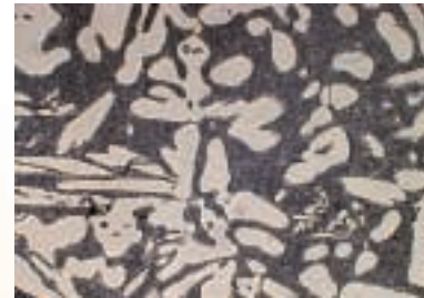
Gefüge: Austenit mit intermetallischen Phasen und Restferrit
