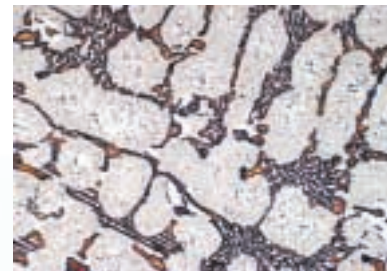
Gefüge: Ferritische Matrix mit Primär- und Sekundärkarbiden
