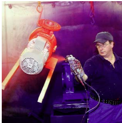
Każdego dnia w fabryce KSB lakieruje się do 300 sztuk pomp. Zdolność produkcyjna lakierni wynosi 70 000 pomp rocznie. Lżejsze modele są transportowe za pomocą systemu power& free, większe podziemnym przenośnikiem taśmowym (na zdjęciu w tle).
