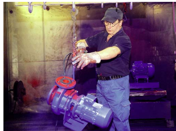
Każdego dnia w fabryce KSB lakieruje się do 300 sztuk pomp. Zdolność produkcyjna lakierni wynosi 70 000 pomp rocznie. Lżejsze modele są transportowe za pomocą systemu power& free, większe podziemnym przenośnikiem taśmowym (na zdjęciu w tle).
