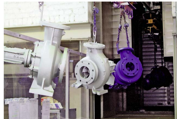
Po lakierowaniu i osuszeniu w piecu pompy są przekazywane do montażu końcowego, a następnie przygotowywane do wysyłki. Cały proces jest sterowany za pomocą systemu SAP.
